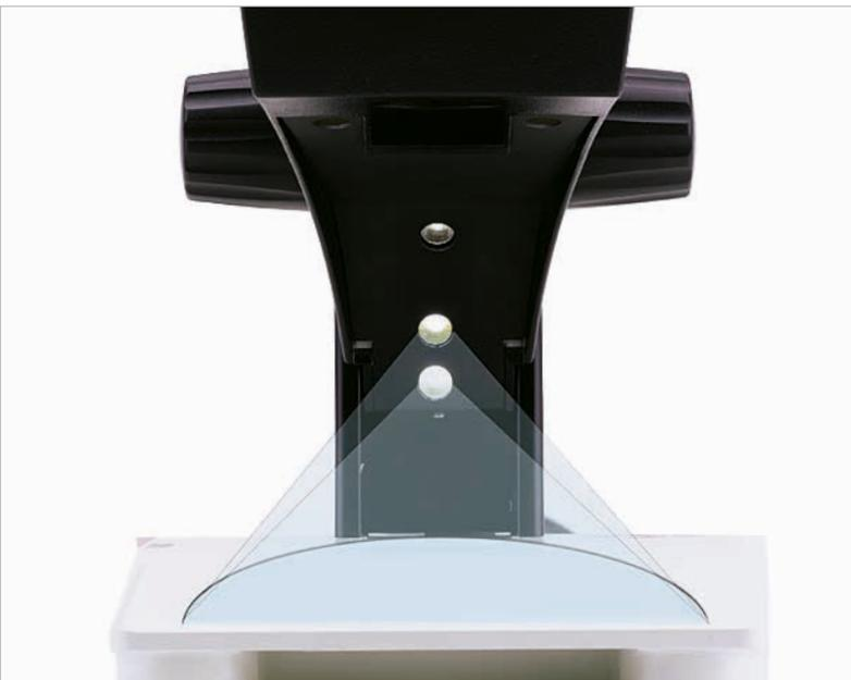
Épiscopie de niveau 3 : les 2 LED inférieures éclairent à plat les objets aux structures fines et augmentent ainsi le contraste.
